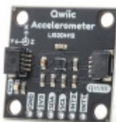
Triple Axis Accelerometer Breakout - LIS2DH12 (Qwiic)
