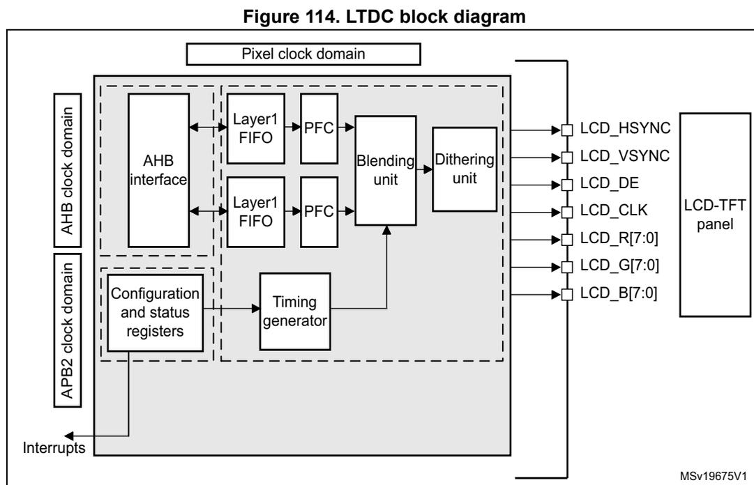
Layer FIFO: One FIFO 64x32-bit per layer.
