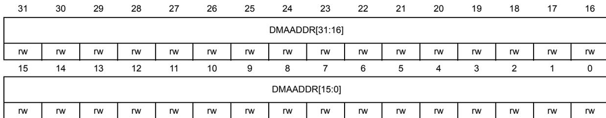
Bits 31:0 **DMAADDR[31:0]**: DMA Address
