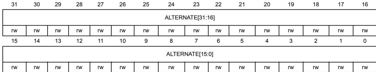
Bits 31:0 **ALTERNATE[31:0]**: Alternate Bytes
