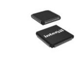
Intersil IC MPU 80C286 16MHZ 68PLCC
